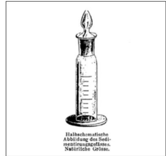
Rycina 3. Przyrząd zaprojektowany przez Edmunda F. Biernackiego do pomiaru szybkości opadania krwinek czerwonych
